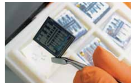
Lab-on-chip en microtechnologie silicium pour analyses biologiques. © P. Avavian, CEA
